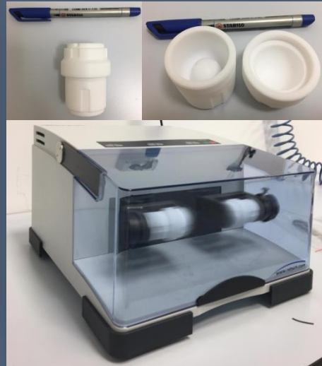
Macinazione criogenica mediante l'utilizzo di un crio mulino MM 400 Retsch
