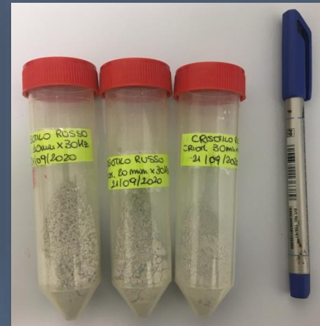
Frazioni ottenute a 10, 20, 30 minuti, con frequenza massima di 30Hz
